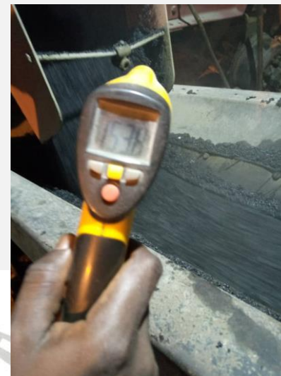
Contrôle régulier de la T° lors de la production/tenir compte des types de liant(35-50 ou 60-70)
