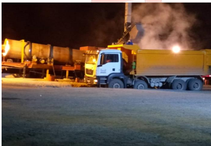
Enlèvement enrobé produit avec une T° élevée
